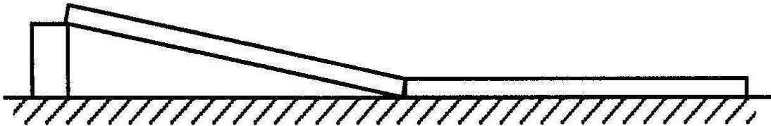
Echa a andar tres relojes simultáneamente. Suelta un balón desde el reposo en la parte alta de la sección inclinada y déjalo que ruede. Detén uno de los relojes cuando sueltes el balón, otro cuando el balón llegue al inicio de la sección horizontal y el tercero cuando el balón llegue al final de la sección horizontal. Calcula la aceleración en la sección inclinada de la pista.
