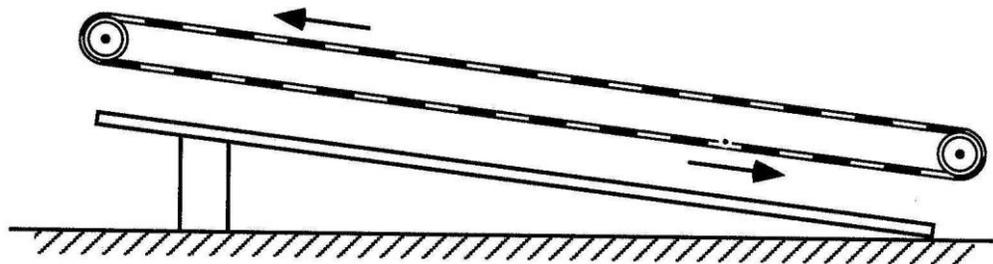
Haz funcionar la banda con una rapidez baja. Suelta el balón del reposo y mide cuánto tiempo se requiere para que el balón alcance la rapidez de la banda.
