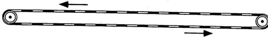
La banda proporciona una rapidez constante que puedes comparar con el movimiento del balón rodando en un riel. Observando simultáneamente el balón y la banda, puedes identificar el instante en el cual los dos tienen la misma rapidez.
